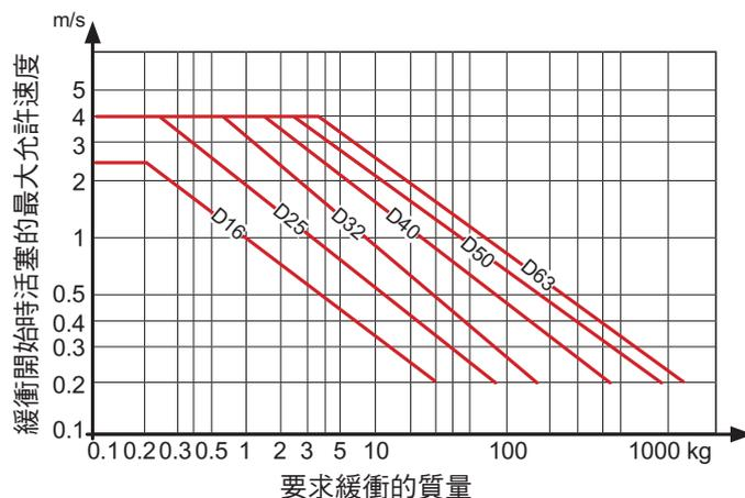
對於帶線性導桿或制動的氣缸, 請將托架或制動機架的質量考慮進去。
