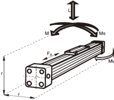
$M = F \cdot r$  彎曲力矩在線性推進器的中點計算, F 指實際的力。
