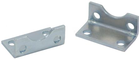
每端蓋的端面有四個螺紋孔用以安裝端蓋支架，因此四螺紋孔成直角分布，故支架可安裝於底部、頂部或任意邊而勿需考慮氣源接口位置。
