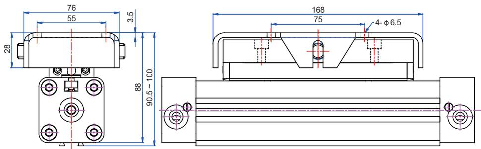
**RLO-U** 標準氣缸含浮動座 / 外型尺寸
